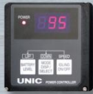
Misuratore digitale della batteria
