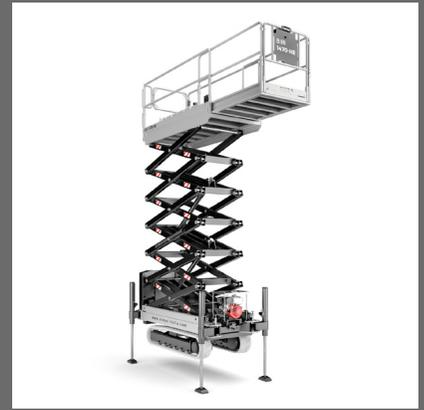
BIBI, mini-scissor cingolato in grado di operare ad altezze di 14 metri. La trazione cingolata permette di superare tutti i limiti della tradizionale trazione 4x4 garantendo la possibilità di operare in spazi ridotti. Il livellamento automatico della piattaforma, permette di operare con assoluta semplicità e sicurezza anche in condizioni di forte pendenza o terreni accidentati. La doppia motorizzazione, a scoppio ed elettrica, offre assoluta versatilità di impiego, all'esterno come all'interno
